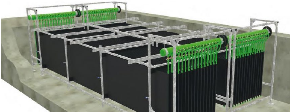
Figuur 20: Betonnen bak met twee warmtewisselaars van MEFA Energy Systems
