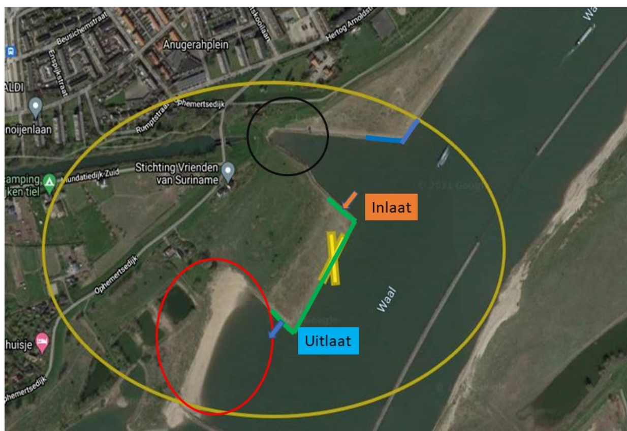
Figuur 16: Voorgestelde locatie in- en uitlaatopening (groene lijn). Het gele kruis heeft geen verdere betekenis.
